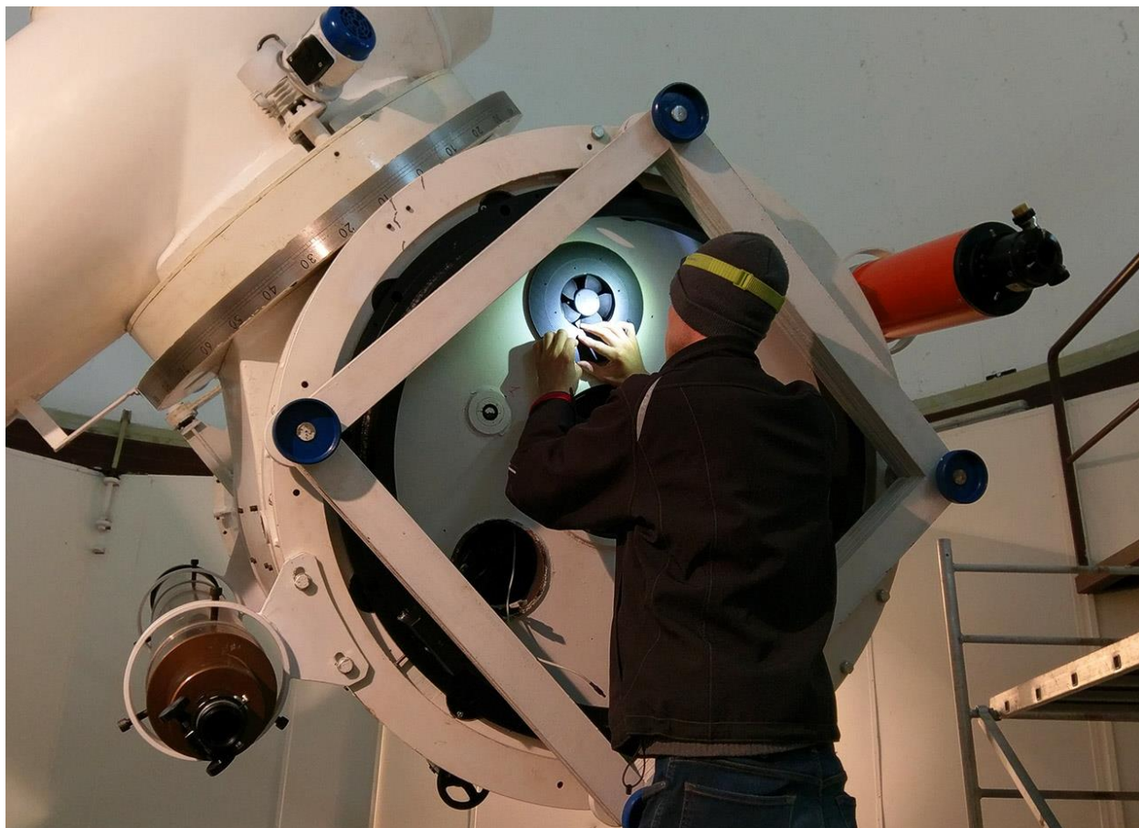
Slika: Postavljanje dodatnog sustava za hlađenje glavnog zrcala teleskopa TT1 na Tičanu.
